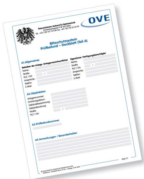
Blitzschutzsysteme sind in regelmäßigen Abständen zu überprüfen und das Ergebnis ist in Form von Prüfbefunden festzuhalten. Sowohl einfache Objekte wie Einfamilienhäuser, als auch komplexe Blitzschutzsysteme, wie sie in Industrieanlagen oder explosionsgeschützten Objekten zum Einsatz kommen, können damit dokumentiert werden.
