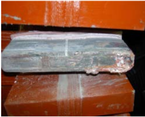
Abbildung 6.5-2: Rechtzeitige Erkennung von Lötstellenfehlern durch Schutzeinrichtung, geringes Schadensausmaß
