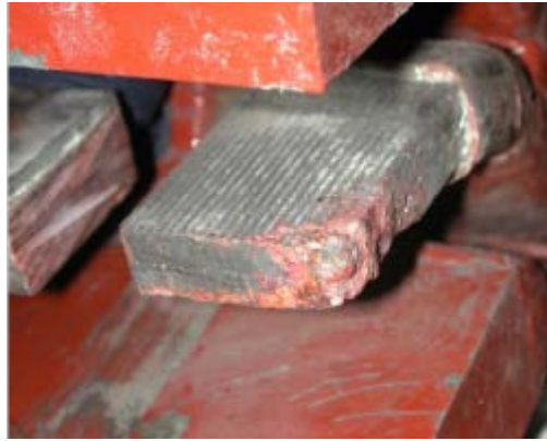
Abbildung 6.5-2: Rechtzeitige Erkennung von Lötstellenfehlern durch Schutzeinrichtung, geringes Schadensausmaß
