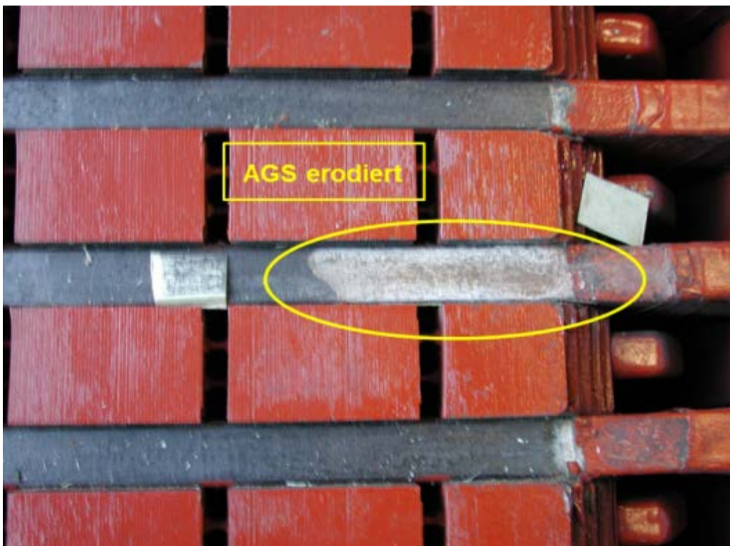
Abbildung 6.2-2: Lokale AGS-Beschädigung durch lockeren Nutverschlusskeil und durch Teilentladungserosion
