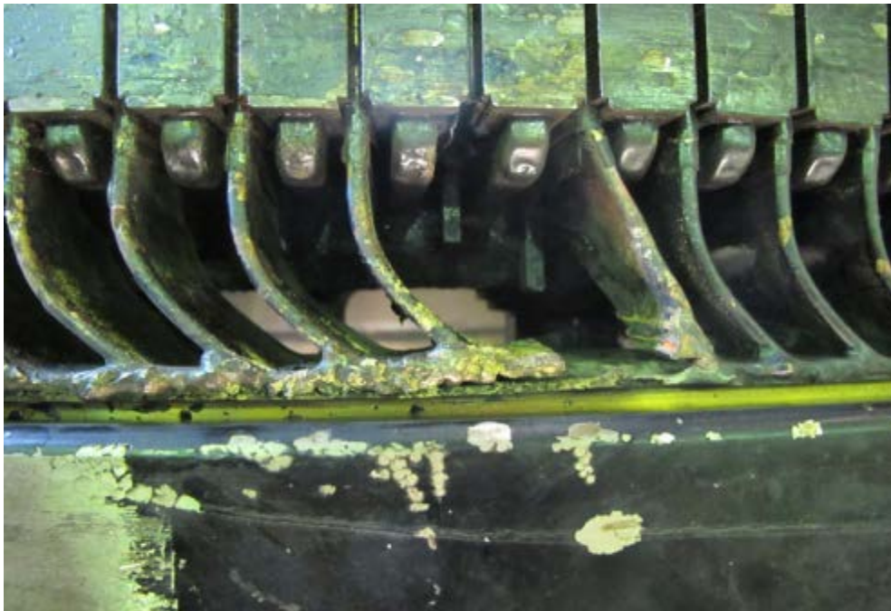
Abbildung 6.8-2: Kurzschlussläufer, gebrochener Käfigstab
