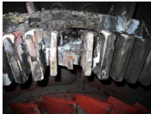
Abbildung 6.5-3: Massiver lokaler Brandschaden durch überhitzte Weichlotverbindung mit Lichtbogeneinwirkung und massiven Abschmelzungen
