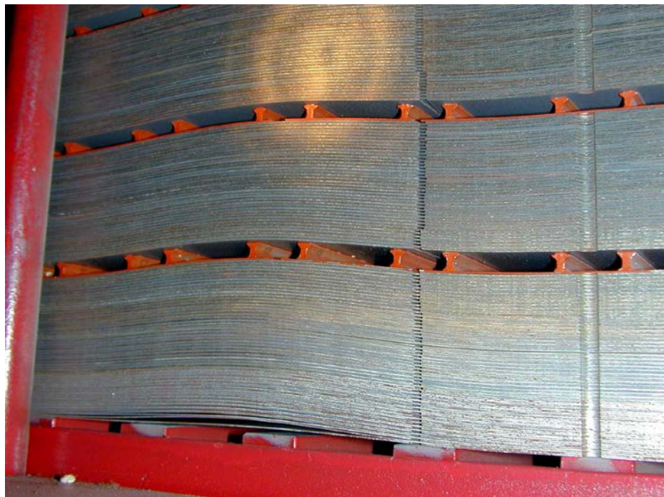
Abbildung 5.12-1: Typisches Verformungsbild am Blechpaketrücken aufgrund der Blechpaketbeulung
