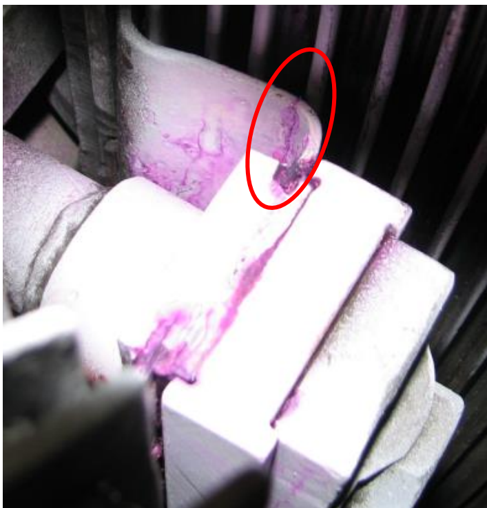
Abbildung 6.6-2: Einriss in einer Polverbindungslasche
