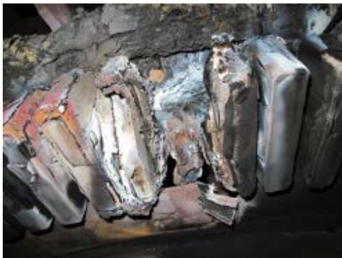
Abbildung 6.5-3: Massiver lokaler Brandschaden durch überhitzte Weichlotverbindung mit Lichtbogeneinwirkung und massiven Abschmelzungen
