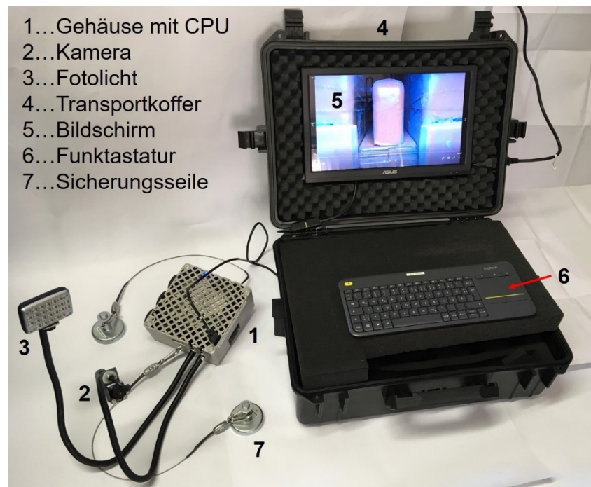
Abbildung 5.14-1: Buckling Visualization System Eigenentwicklung Verbund Hydro Power GmbH
