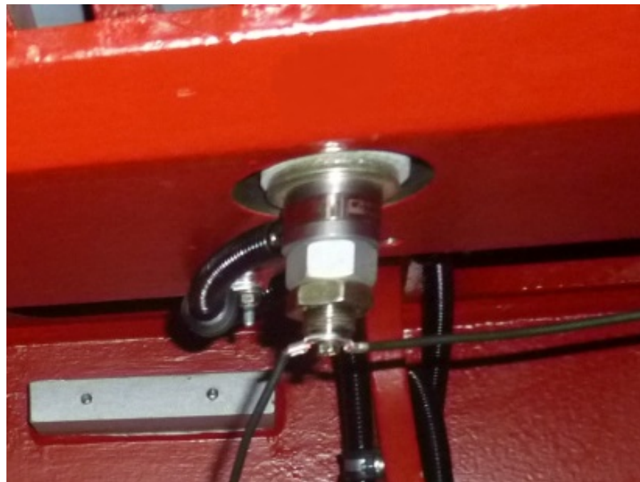
Abbildung 5.12-2: Kraftmessring im eingebauten Zustand
