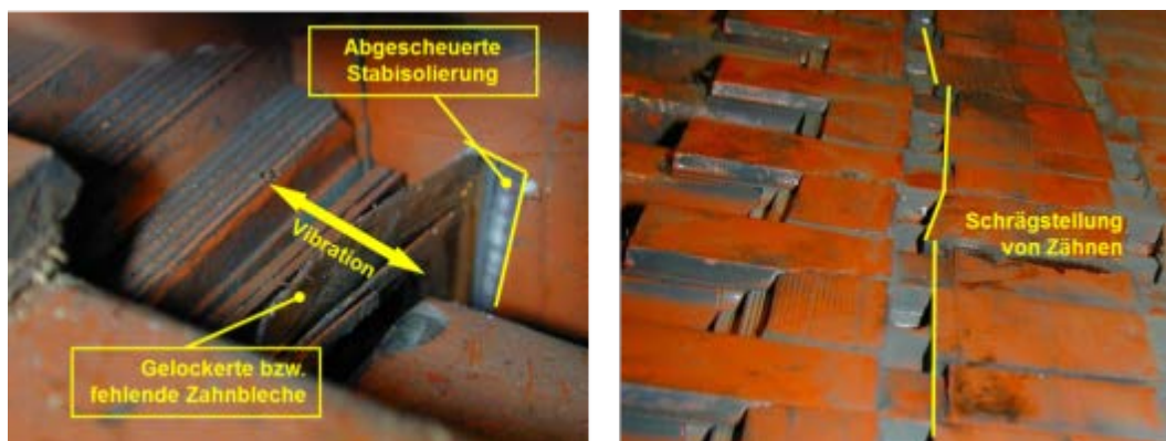
Abbildung 6.4-2: Blechpaketbuckling, gelockerte, vibrierende Endzähne
